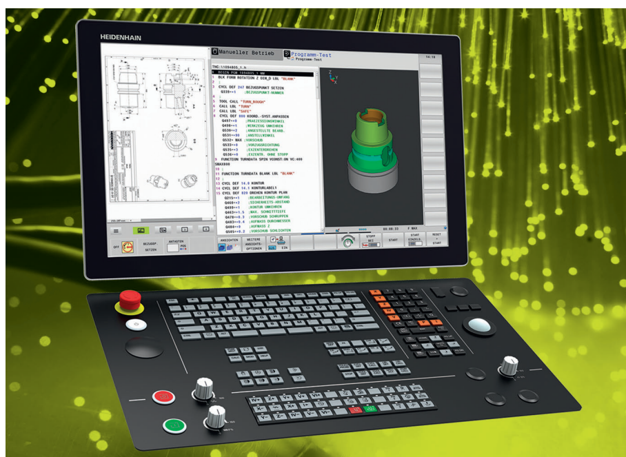
1 Prozesse und Aufträge immer im Blick: Dank ihres geteilten Bildschirms bietet die neue TNC 640 mit 24“-Widescreen und Extended Workspace Compact parallel zwei Arbeitsbereiche für den Steuerungsbildschirm und die Anzeige weiterer Applikationen (© Heidenhain)
